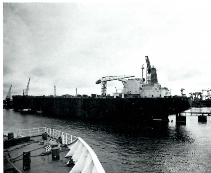
Het s.s. „Melania” — van twee helften een schip uit één stuk.
